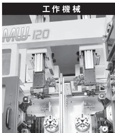
ムラテックの工作機械は、高精度なターニングマシンと搬送装置を一体化した、コンパクトな自動化システムが特長。世界の自動車産業をサポートしています。
